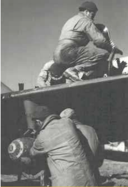
Meccanici brasiliani impegnati nelle operazioni di ricarica delle mitragliatrici e del posizionamento di una delle due bombe da 500 libbre
